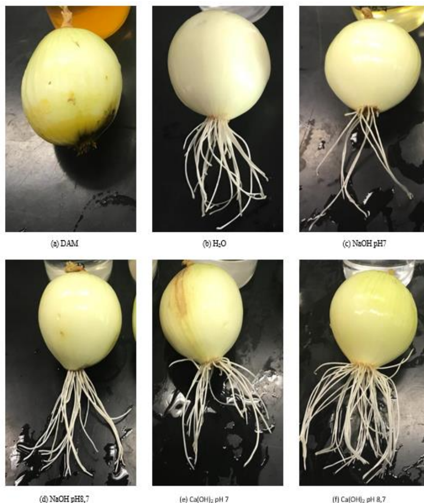
Figura 23 – Imagens de desenvolvimento das raízes de Allium cepa após o contato com as seguintes soluções: (a) drenagem ácida de minas bruta (DAM) ; (b) água – amostra de controle; (c) DAM tratada com NaOH em pH 7,0 (d) DAM tratada com NaOH em pH 8,7 (e) DAM tratada com Ca(OH) 2 em pH 7,0; e (f) DAM tratada com Ca(OH) 2 em pH 8,7.
