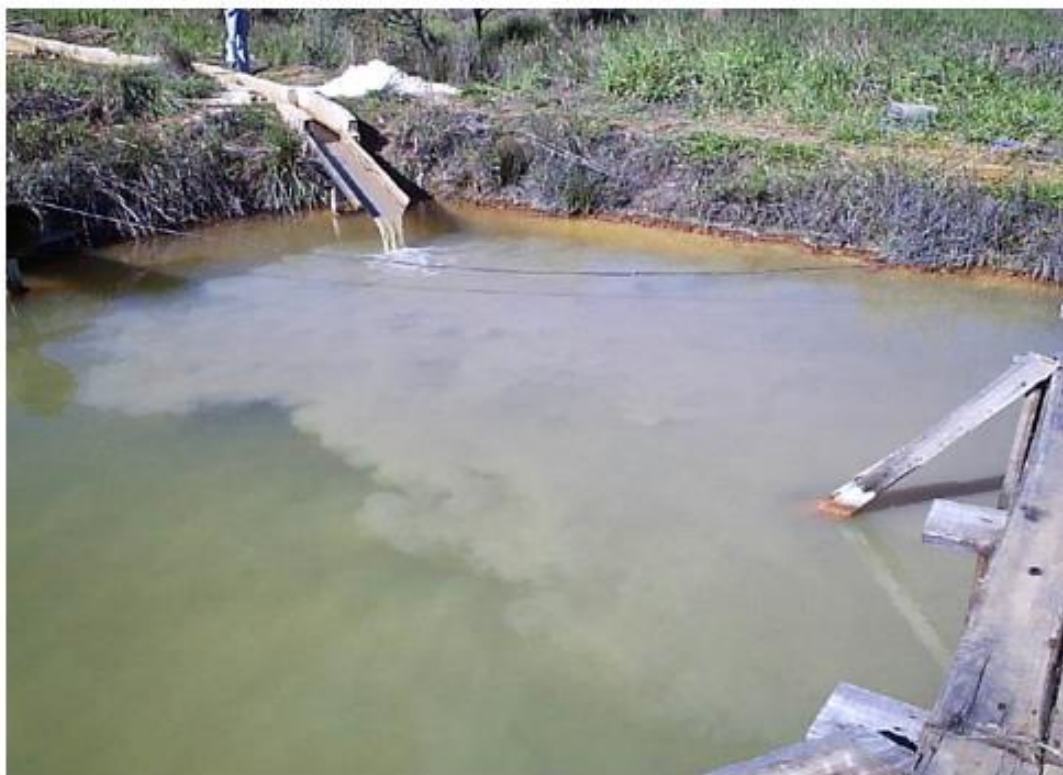
Figura 4- Tratamento de drenagem ácida de minas na Carbonífera do Cambuí com hidróxido de cálcio Fonte: CAMPANER (2005).
