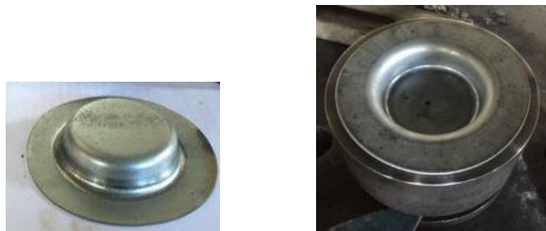
Figura 4.24 Resultado da estampagem profunda do material bifásico (DP600 – 1mm).
