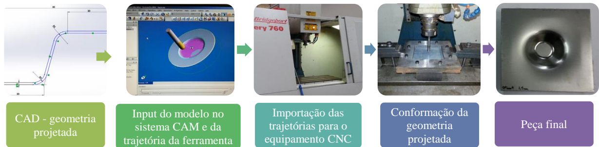
Figura 3.18 Sequência das etapas para realização do processo de estampagem incremental. Fonte: Elaborado pela autora.
