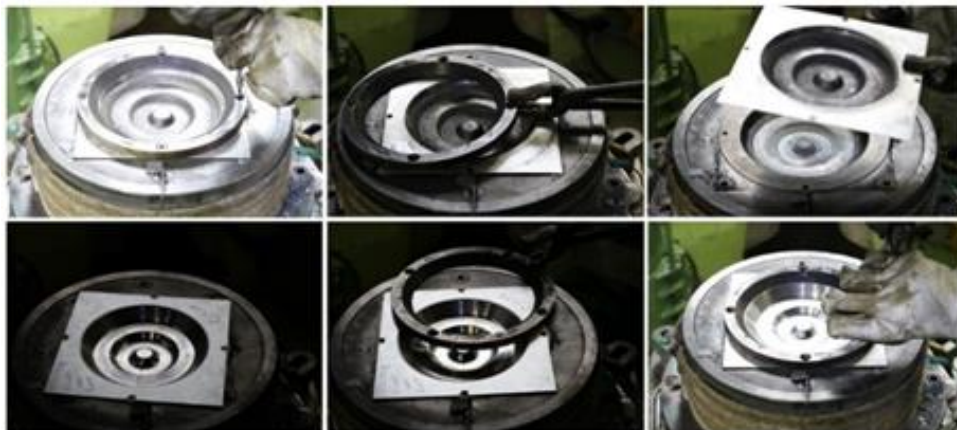
Figura 4.56 Experimento I de forjamento: (a) etapas do ciclo de forjamento, (b) troca das máscaras e fixação.
