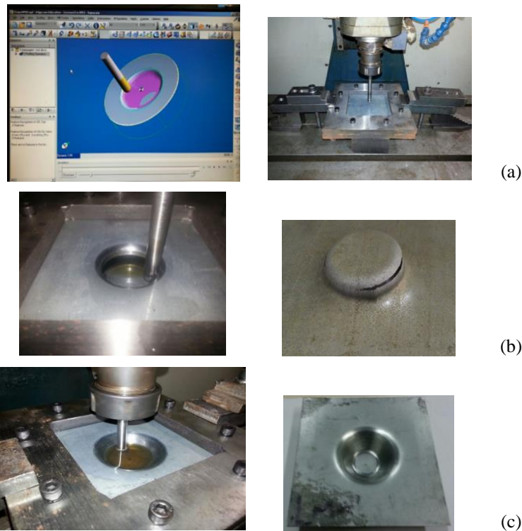
Figura 4.25 Processo de estampagem incremental: (a) setup, (b) geometria copo cilíndrico e (c) copo cônico.
