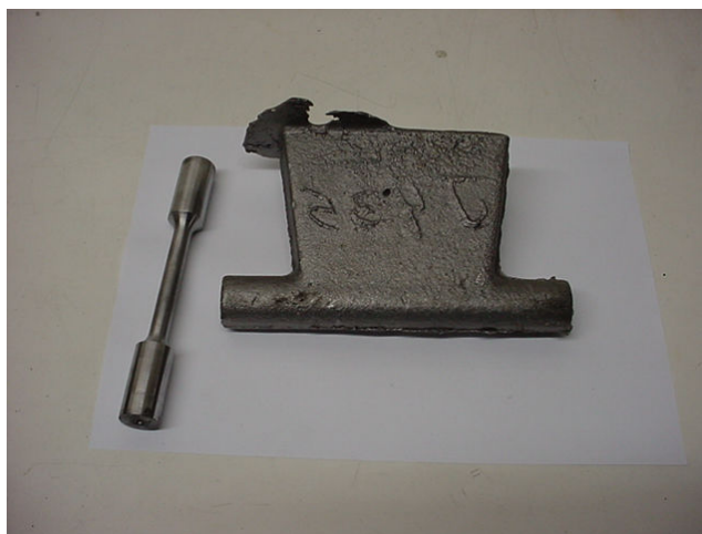
Figura 3.1 Ilustração do corpo de prova. À direita corpo de prova fundido com o canal de alimentação e a esquerda depois de cortado e usinado.
