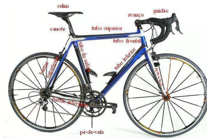
Figura 2.7 - Bicicleta e a denominação dos seus tubos constituintes.
