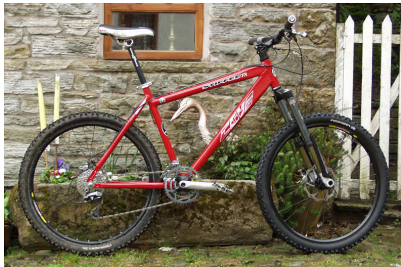
Figura 2.2 - A bicicleta com quadro diamante, dois triângulos. (fonte: Moore 2004)
