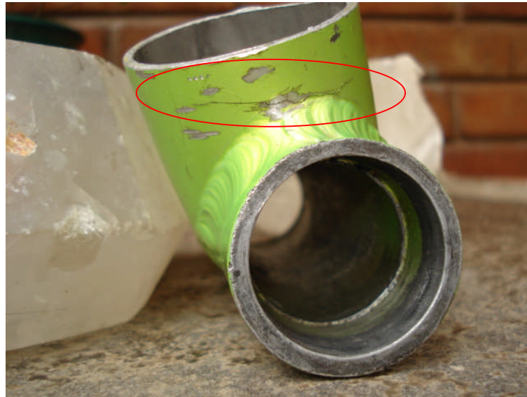
Figura 4.1 - Recorte do quadro com a falha - trinca.
