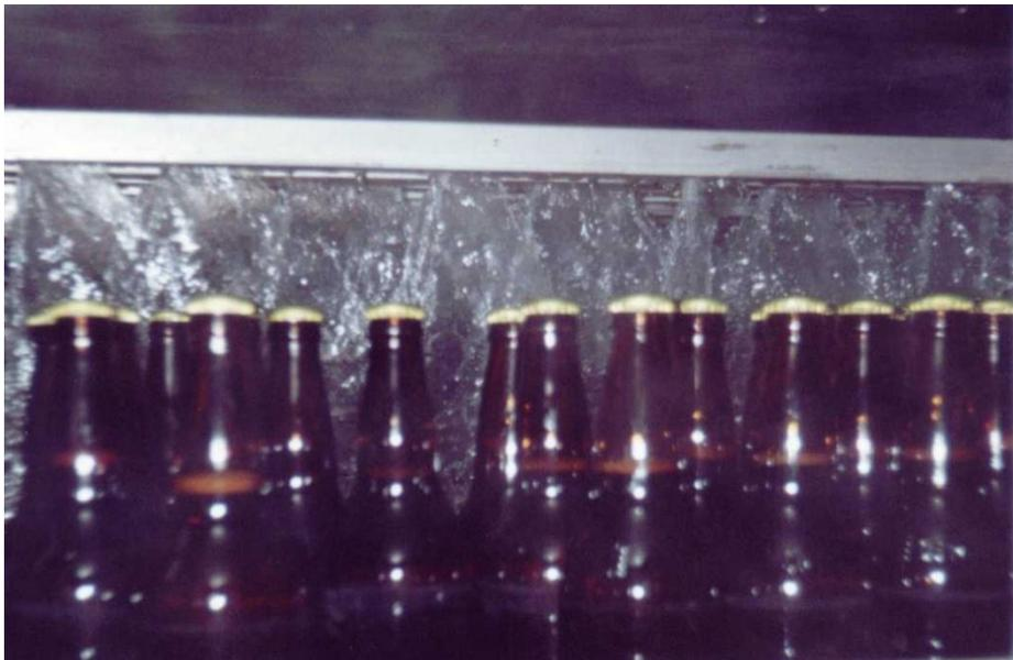
Figura 3.12 - Tubo quadrado com recorte em “U” esguichando em um túnel de pasteurização (Fonte: Ziemann-Liess)
