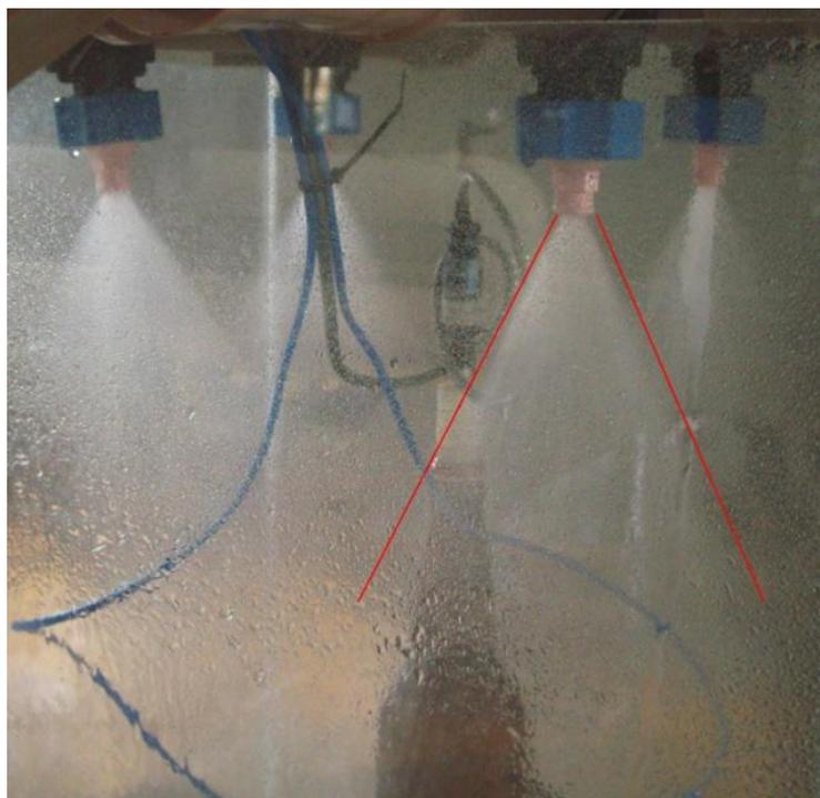
Figura 4.5 – Esguichos marca Bete instalados na bancada e a indicação do cone com um ângulo de 65° produzido pelo aspersor
