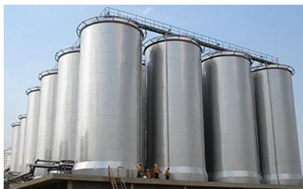
Figura 1.2 - Tanques de fermentação e maturação da cerveja (Fonte: [www.zl.ind.br](http://www.zl.ind.br))
