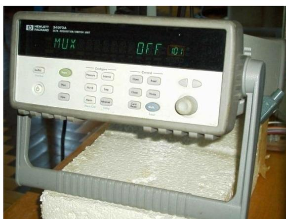
Figura 3.7 – Aquisidor de sinal instalado na bancada
