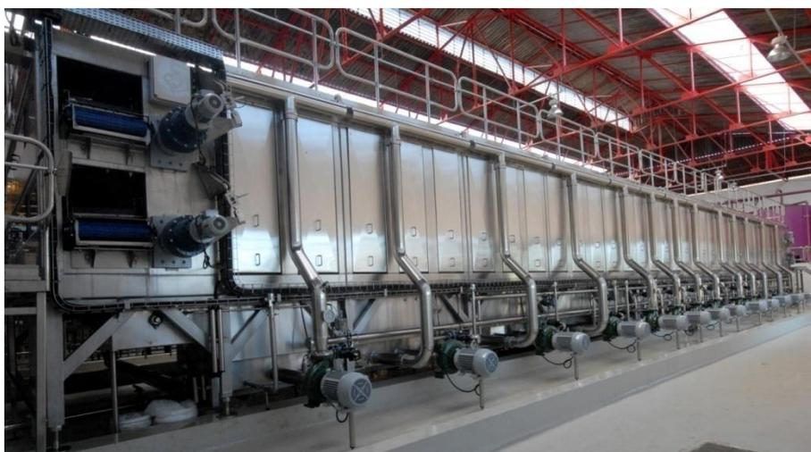
Figura 2.2 – Túnel de pasteurização para cerveja (fabricante Ziemann-Liess)
