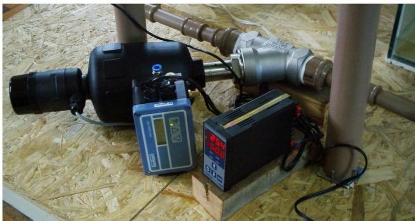
Figura 3.6 – Válvula atuada por ar comprimido e o controlador de processo
