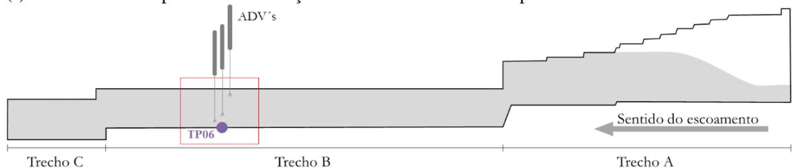
(f) Escoamento de água ocupando a seção transversal ao longo de toda a porção a jusante da rampa.
