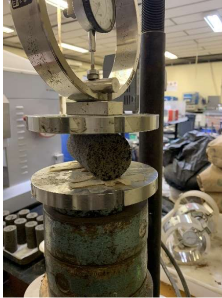
Figura 3.9 - Ensaio de compressão diametral
