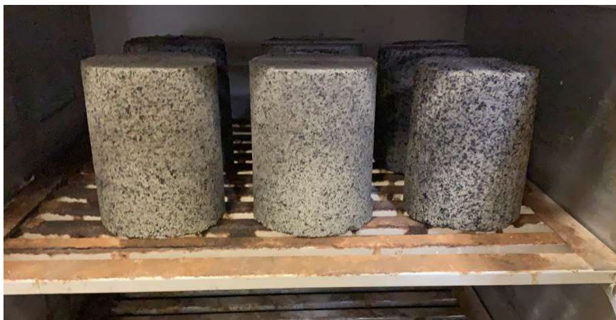
Figura 3.11 - Amostras de durabilidade na estufa
