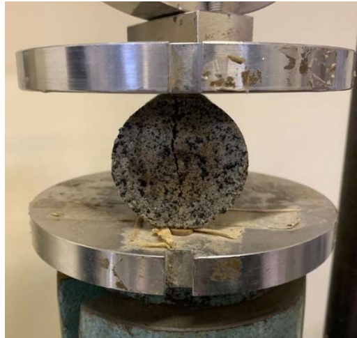
Figura 4.5 - Amostra submetida a ensaio de compressão diametral
