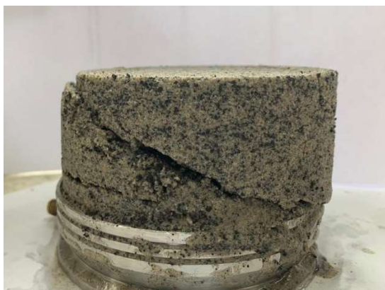
Figura 4.15 - Amostra após ensaio Simple Shear monotônico
