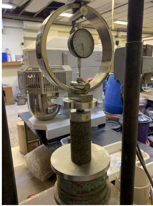
Figura 3.8 - Ensaio de compressão simples
