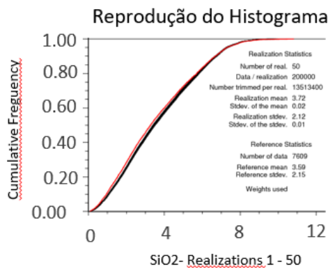
Figura 3-30 - SiO 2 - Reprodução dos histogramas das 50 SGSs (preto) e dos dados originais (vermelho)
