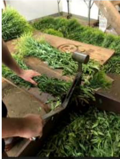
Figura 18 – Guilhotina utilizada para o corte das hastes de Solidago canadensis , padronizando-as em 80 cm de comprimento.
