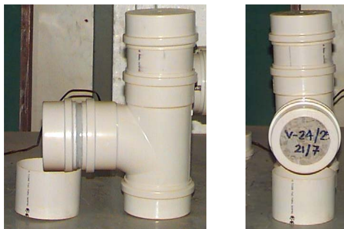
Figura 4.11 Célula positiva utilizada no ensaio.
