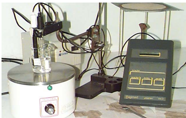
Figura 4.14 Determinação da concentração de cloretos através do eletrodo de íon seletivo
