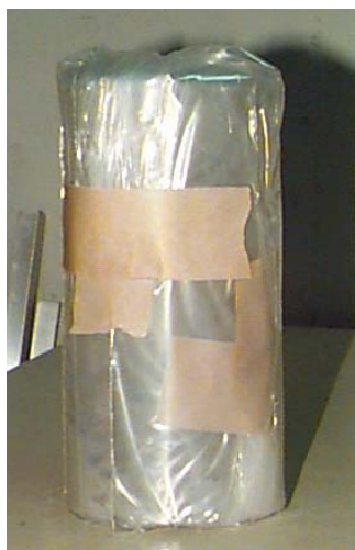
Figura 4.4 Corpo-de-prova embalado com plástico anteriormente a exposição aos ambientes de cura.
