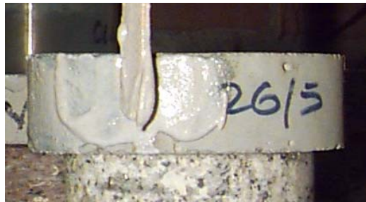
Figura 4.10 Fatia de 2,5cm retirada da parte central do corpo-de-prova revestida com resina epoxi
