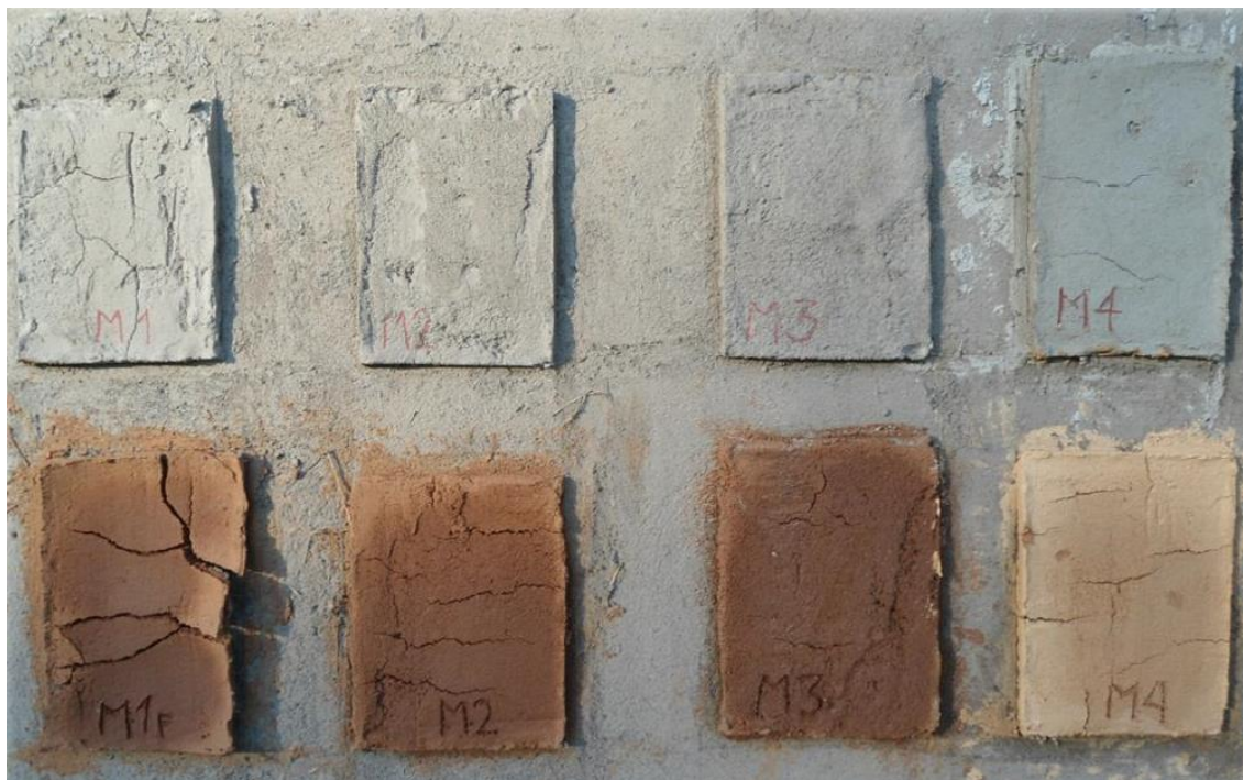
Figura 5: Ensaio de retração para obtenção de traço de argamassas com bases cimento e terra Fonte: Cartilha de Bioconstrução em terra crua, Espaço Naturalmente.
