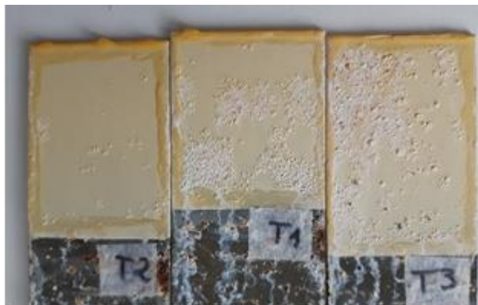
Figura 17. Aspecto visual das amostras que foram submetidas ao pré-tratamento proposto. (Ensaio de névoa salina)
