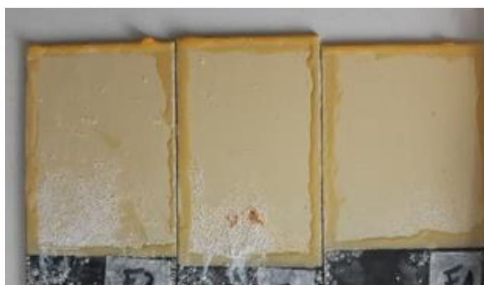
Figura 16. Aspecto visual das amostras que foram submetidas ao pré-tratamento de fosfatização. (Ensaio de névoa salina)
