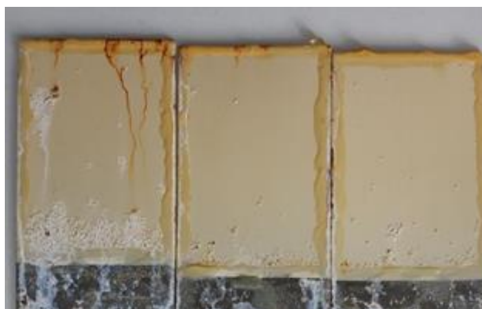
Figura 15. Aspecto visual das amostras que foram somente pintadas. (Ensaio de névoa salina)
