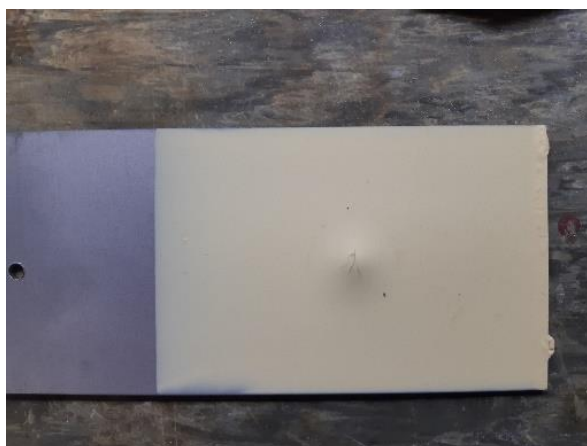
Figura 18. Aspecto da região em que ocorreu o ensaio de impacto nas amostras que foram somente pintadas. (Método de teste padrão para resistência de revestimentos orgânicos sob efeito de rápida deformação – ASTM D2794)
