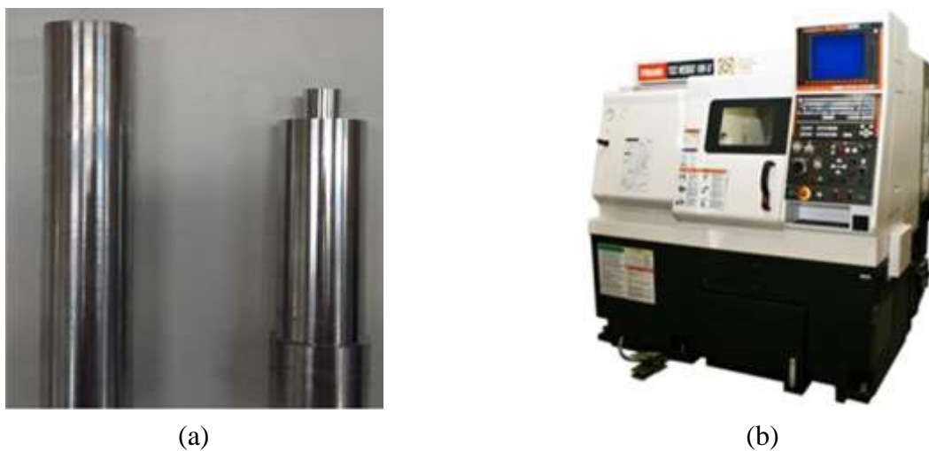
Figura 2 – (a) Foto do corpo de prova antes e após ser preparado para os ensaios; (b) Foto do torno CNC Mazak QTN 100-II presente no LAUS-UFRGS
