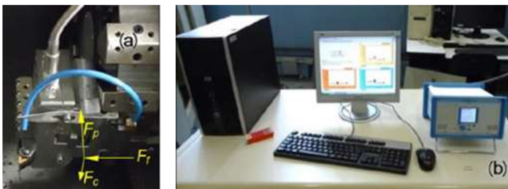
Figura 6 – (a) Dinamômetro piezelétrico Kistler 9129A instalado no torno CNC; (b) Sistema monitor.
