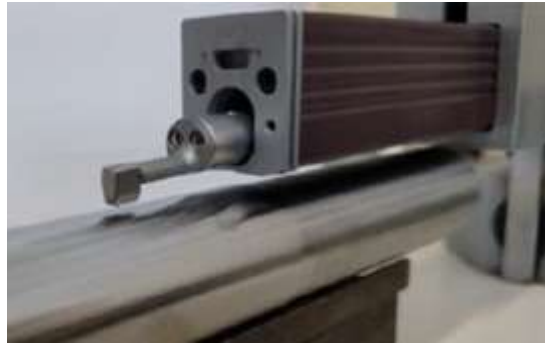
Figura 7 – Medição em peça torneada com rugosímetro Mitutoyo SJ-201P.
