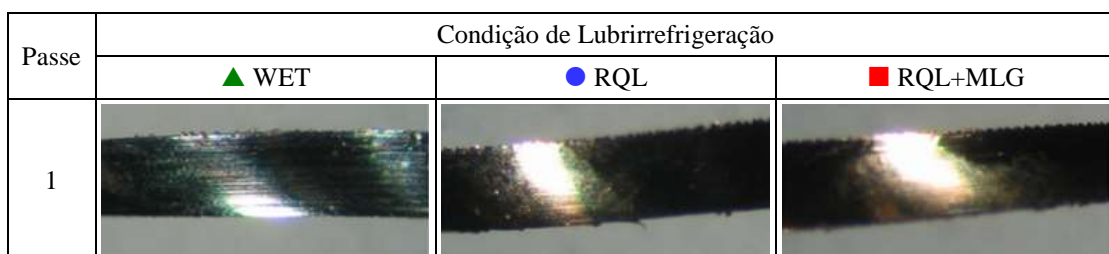
Figura 14 – Imagens com amplificação de 20x dos cavacos coletados após o primeiro passe dado, nas três condições de lubrificação.
