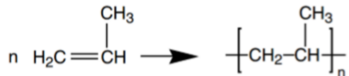
Figura 2 – Reação de obtenção do polipropileno (PP).
