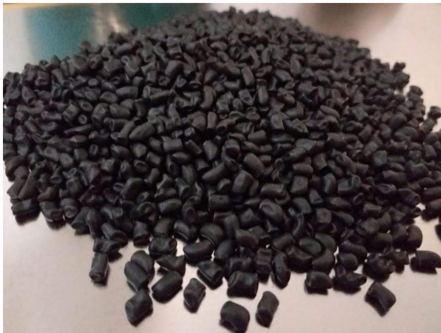
Figura 9 – Pellets de composto de polipropileno e EPDM com 12% de talco, matéria prima para injeção de para-choques.
