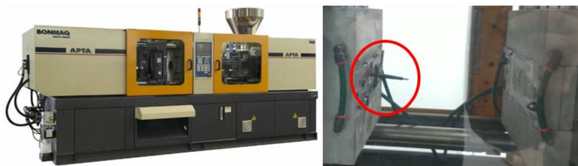
Figura 12 – Imagem da injetora usada no processamento à esquerda. Detalhe do corpo de prova ainda no molde aberto após a injeção, à direita.
