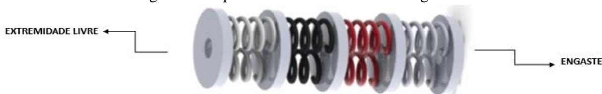
A extremidade inicial trata-se de um engaste e o local onde as forças que tracionam os cabos são aplicadas, para este estudo foi considerado o acionamento manual. A extremidade final trata-se de uma extremidade livre para girar via deformação das molas.
