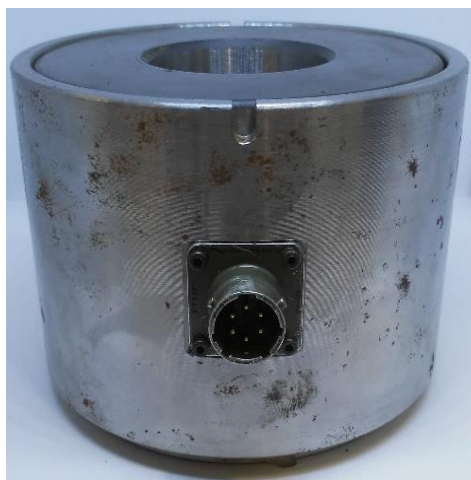
Figura 15 – Célula de carga com capa de proteção e conector IP68.
