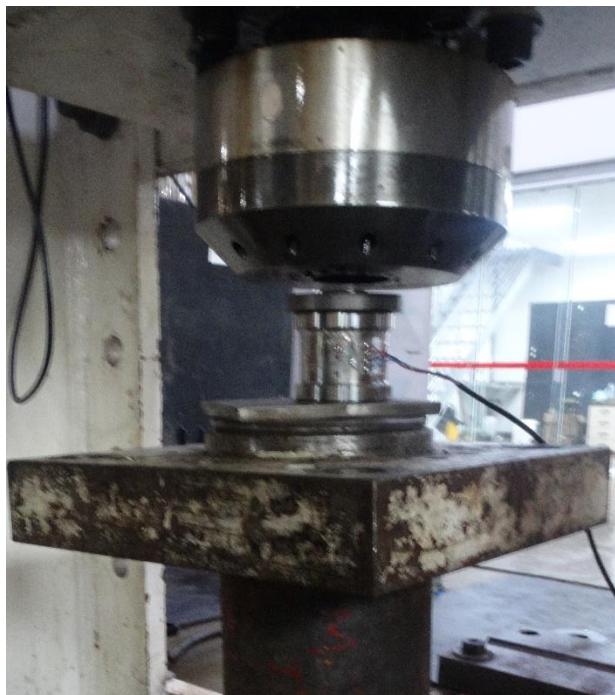
Figura 16 – Esquema de montagem e associação das células de carga para calibração.
