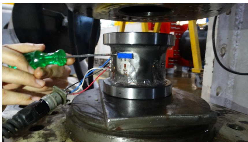
Figura 17 – Ajuste da resistividade da ponte de Wheatstone.
