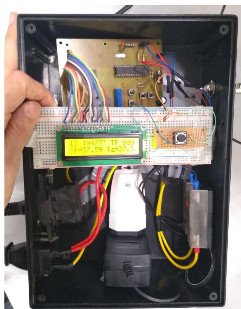
Figura 1. Protótipo do controlador de temperatura.
