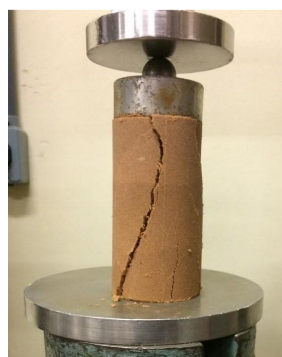
Figuras 1 e 2: CP antes e depois do ensaio de compressão simples.
