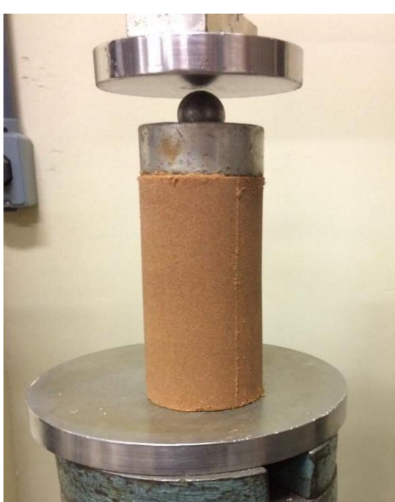
Figuras 1 e 2: CP antes e depois do ensaio de compressão simples.
