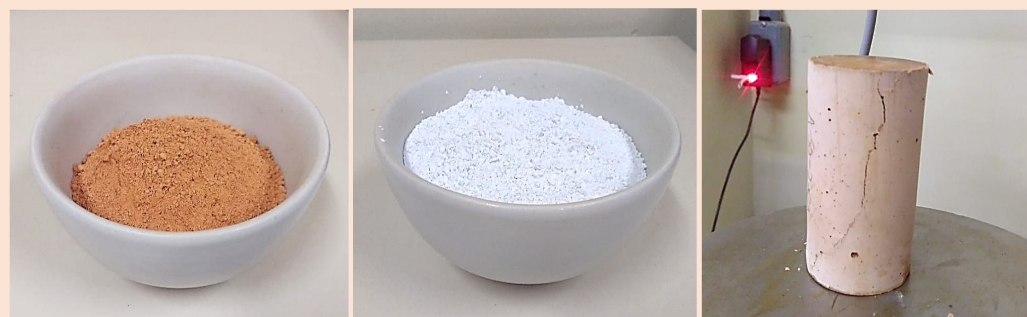
Figuras 3, 4 e 5: cerâmica vermelha (imagem à esquerda), cal de carbureto (imagem no centro) e corpo de prova na prensa logo após ser rompido por compressão simples (à direita).
