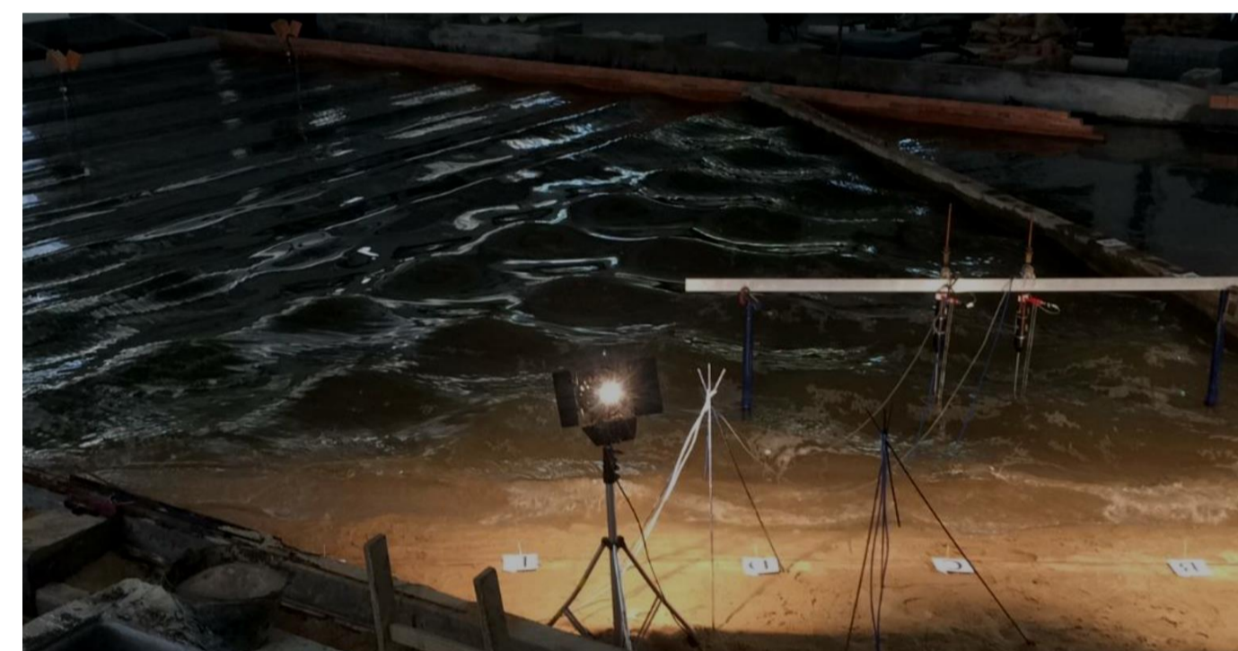
Figura 2: Imagem de um dos experimentos em laboratório. Pode-se ver parte das ondas originais incidindo na parede de reflexão e propagando-se em direção à praia.
