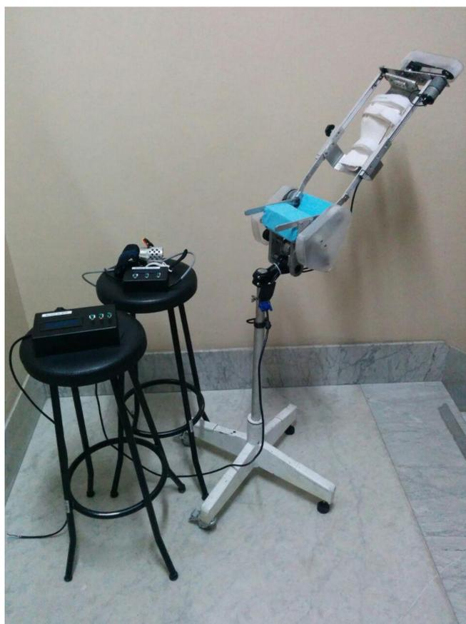
Figura 1. Equipamento para a reabilitação do cotovelo.
