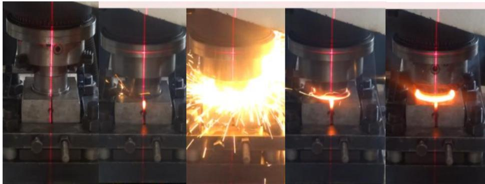
Figura 1: Sequência do processo de soldagem na MPF1000.
