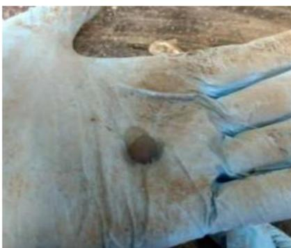
Primeiro, usa-se a argila húmida para fabricar bolinhas manualmente, em diâmetros diversos. Então elas devem ficar 24h secando ao ar livre, e mais 24h secando em uma estufa.
