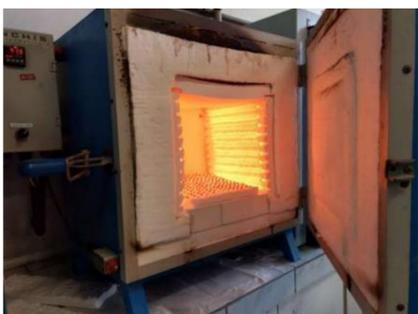
Após secas, as argilas são queimadas em um forno nas temperaturas 1100°C, 1250°C e 1300°C.
