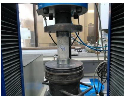
Produzem-se então os corpos de prova (argila expandida + areia + cimento) e são realizados os testes desejados, como a resistência à compressão.
