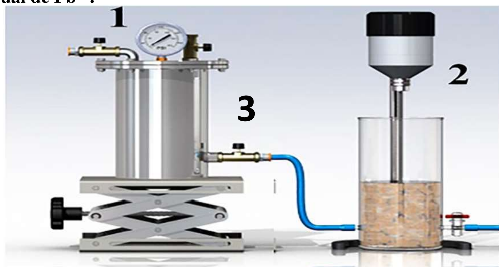
Fig 1: Aparato experimental: (1) vaso saturador; (2) coluna para floculação-separação; (3) válvula agulha
