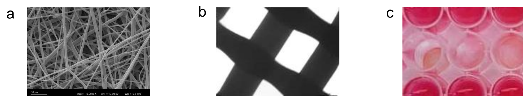
Figura 1. Aspecto dos scaffolds obtidos por meio de eletrofiação (a), impressão 3D (b) e hidrogéis (c).
