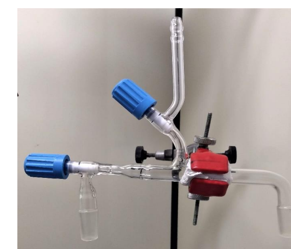
Figura 2. Vidraria utilizada na preparação da sistema de evaporação lenta.
