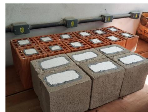
Imagem 5 – preparação dos blocos para o ensaio de push out
