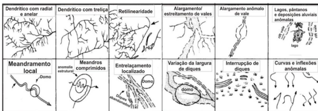
Figura 3 – Exemplos de anomalias de drenagem
