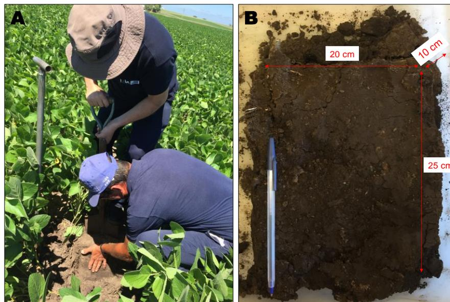
**Figura 5.** Coleta da amostra de solo indeformada (A). Amostra de solo indeformada (25 cm x 20 cm x 10 cm) (B). Foto: Filippi, D. (2019).
