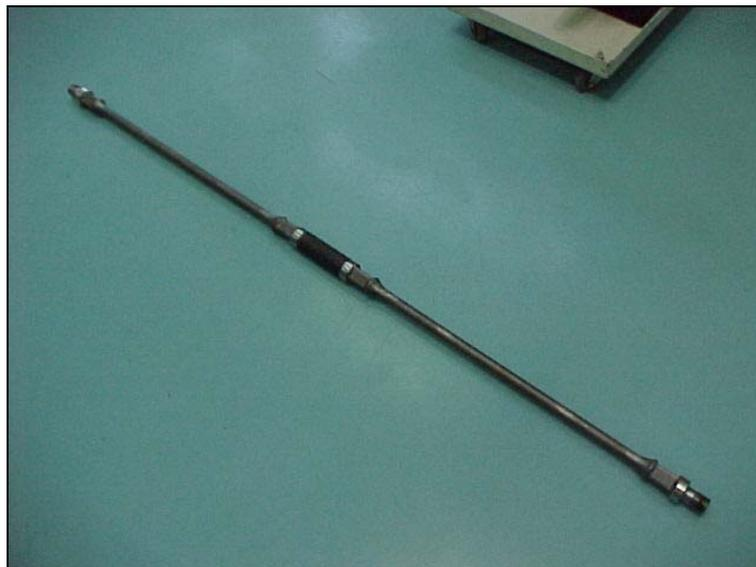
*Figura 4.10 – Acoplamento de 2 hastes em série.*
