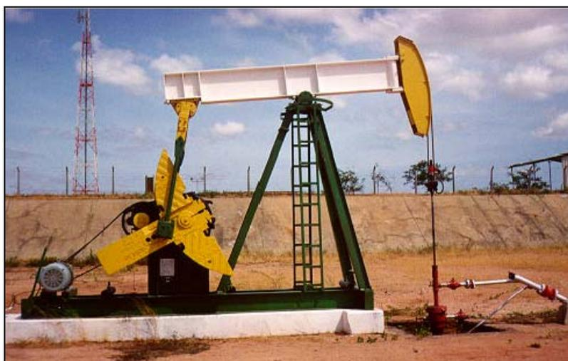
*Figura 1.1 - Equipamento de bombeio mecânico comumente chamado de cavalo-de-pau.*
