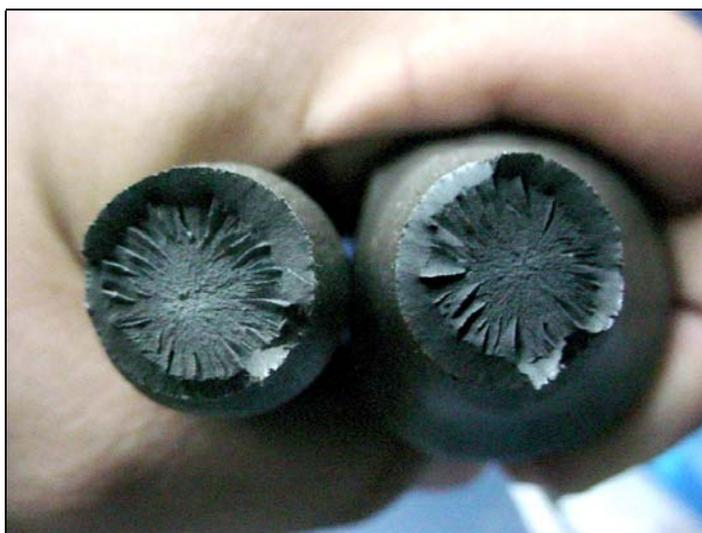
*Figura 5.1 – Fratura tipo taça cone de uma haste de bombeio após ensaio de tração.*
