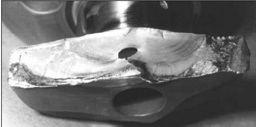
*Figura 3.1 - Falha por fadiga de um virabrequim de motor de combustão interna. Observam-se as marcas de praia características da propagação da trinca de fadiga.*
