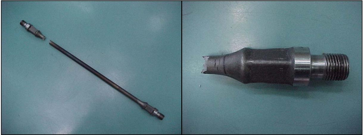
*Figura 5.7 – Fotos da fratura da haste A, com um total de 39148 ciclos.*
