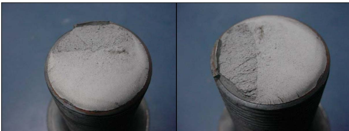
*Figura 5.19 – Fratura na rosca do dispositivo de ensaio ocasionada pela falta de torque no momento da montagem.*
