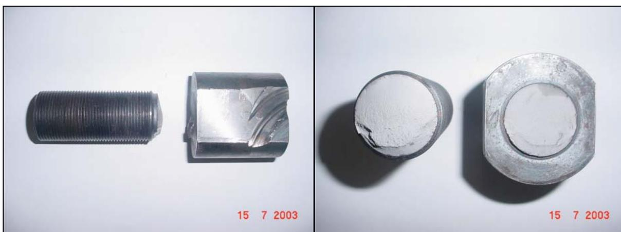
*Figuras 5.15 – Fotografia do dispositivo fraturado, na concordância da rosca com a base superior.*
