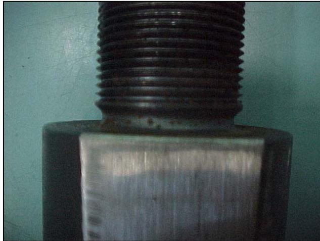
*Figuras 5.17 – Fotografia mostrando o detalhe da concordância entre o parafuso e a base intermediária, parece um concentrador de tensões, possível causa da ruptura.*
