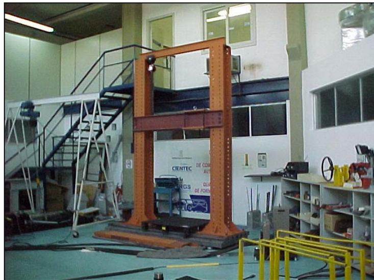
Figura 4.7 – Viga utilizada para fixação do atuador.
