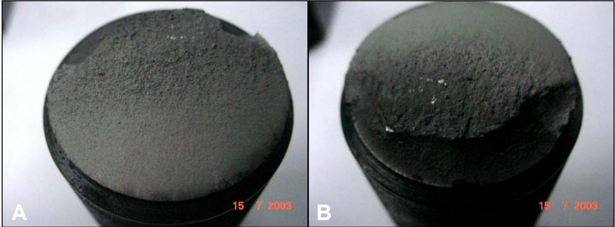
*Figuras 5.16 – Fotografia mostrando a fadiga: a nucleação de microtrincas e sua propagação (A) e a fratura do parafuso pelo fato da carga aplicada ser superior a área resistente(B).*
