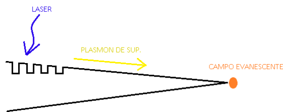
Figura 21- Esquema de acoplamento de um laser em um plásmom de superfície via grade de difração no corpo da nanoponteira.
