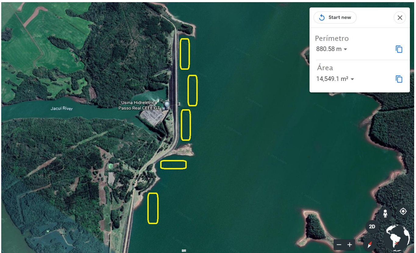
Figura 27 – Ilustração do Possível Tamanho das Usinas Solares Flutuantes em Passo Real
