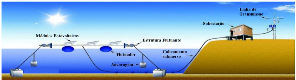
Figura 3 – Simplificação do Sistema de uma Usina Solar Flutuante
