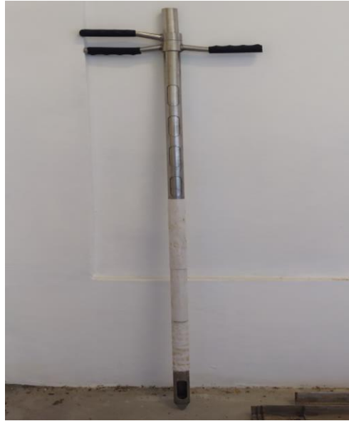
Figura 1C – Imagem do calador graneleiro utilizado para extração das amostras.
