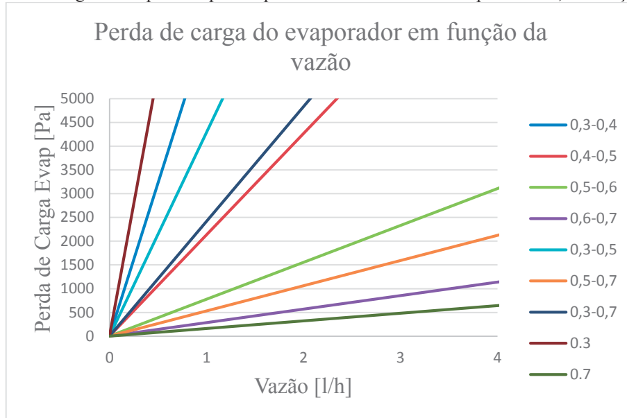
Fig. 8 – Perda de carga no evaporador poroso para diferentes intervalos de porosidade, em função da vazão.
