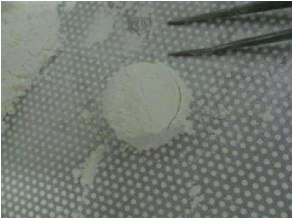
Na sequência das Figura 30 até a Figura 34, observa-se o aspecto das peças com 0, 1, 2 e 3% de alginato de sódio, respectivamente. A adição de 2% de alginato de sódio não afetou a estabilidade dimensional das peças. Com 3% houve desagregação do material devido ao inchamento excessivo do alginato de sódio ocasionando um esforço de dentro para fora no material.
