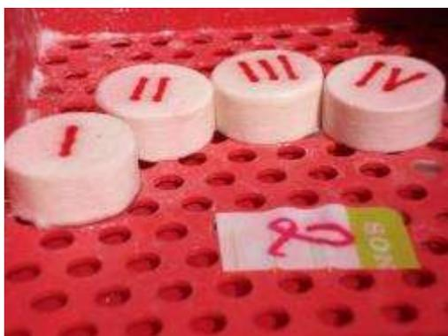
**Figura 33 - Peças prototipadas em impressora 3D com 3% de alginato de sódio e que ficaram em 100% de umidade por um dia.**
