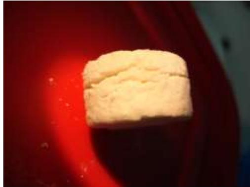
As peças exibidas foram mantidas um dia em 100% de umidade. As peças que foram imersas somente em SBF, não apresentaram a desagregação inclusive para a composição com 3% de alginato de sódio.
