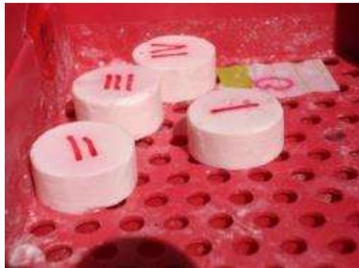
**Figura 31 - Peças prototipadas em impressora 3D com 1% de alginato de sódio e que ficaram em 100% de umidade por um dia.**
