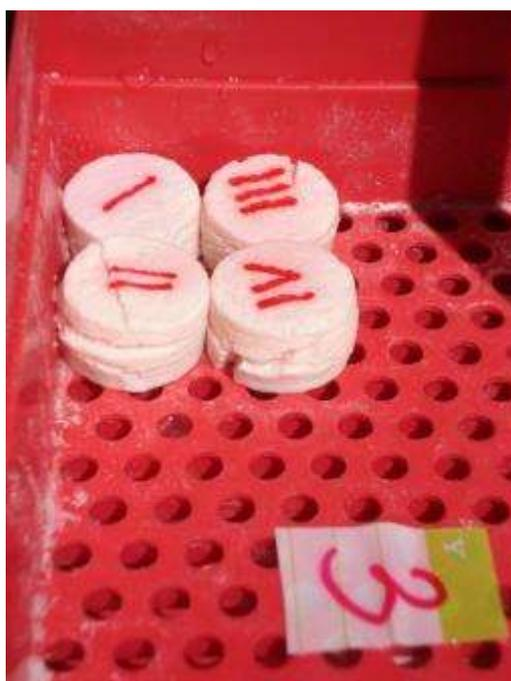
**Figura 34 - Ampliação em uma peça prototipada em impressora 3D com 3% de alginato de sódio e que ficou em 100% de umidade por um dia.**
