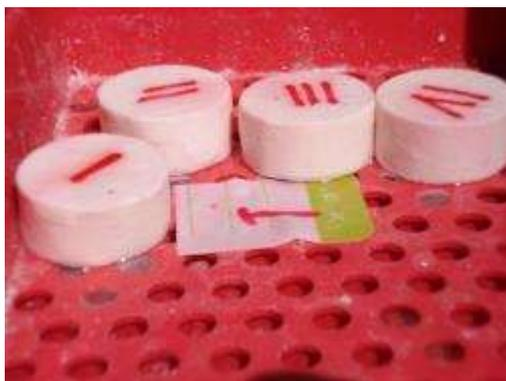
**Figura 32 - Peças prototipadas em impressora 3D com 2% de alginato de sódio e que ficaram em 100% de umidade por um dia.**
