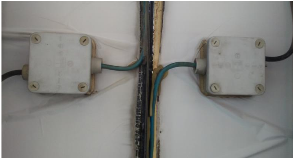
Figura 5.25 Falha da junta de silicone dos módulos e delaminação do filme posterior.
