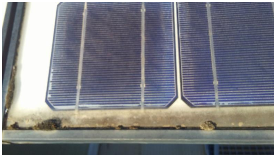
Figura 5.22 Foto aproximada da região inferior do módulo, indicando a decomposição da junta de silicone. Além da observação do fenômeno de escurecimento que se pronuncia no centro da célula, nas periferias observa-se o milkpattern , como processo de delaminação frontal, não registrado nas análises anteriores e provavelmente surgiu no espaço entre medidas. O efeito abrasivo no vidro também é observado.
