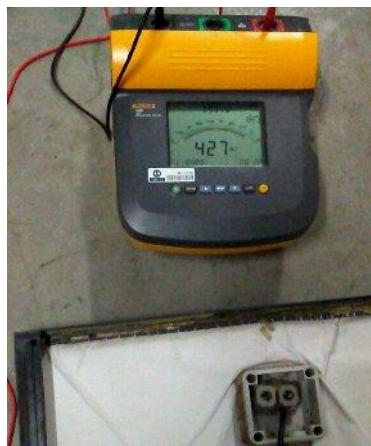
Figura 4.2 Teste de isolamento elétrico realizado com equipamento com a rotina de ensaio de isolamento programada.
