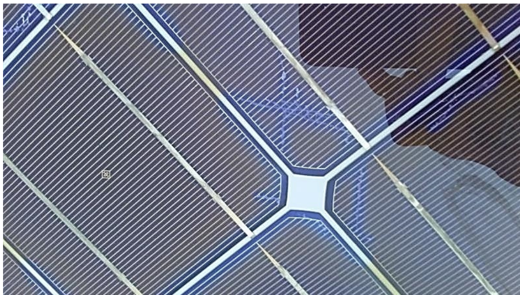
Figura 5.24 Região do módulo apresentando escurecimento e trincas.
