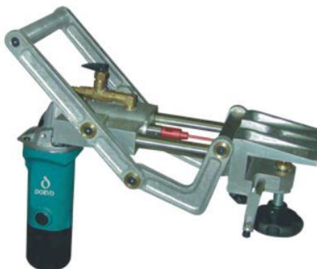
Figura 22: Furadeira adaptada para perfuração. 65
