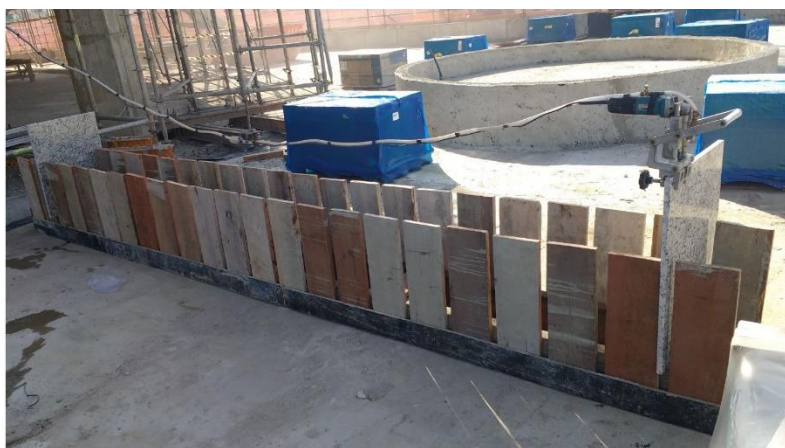
Foto 15: Cavalete para perfuração das faces da placa
