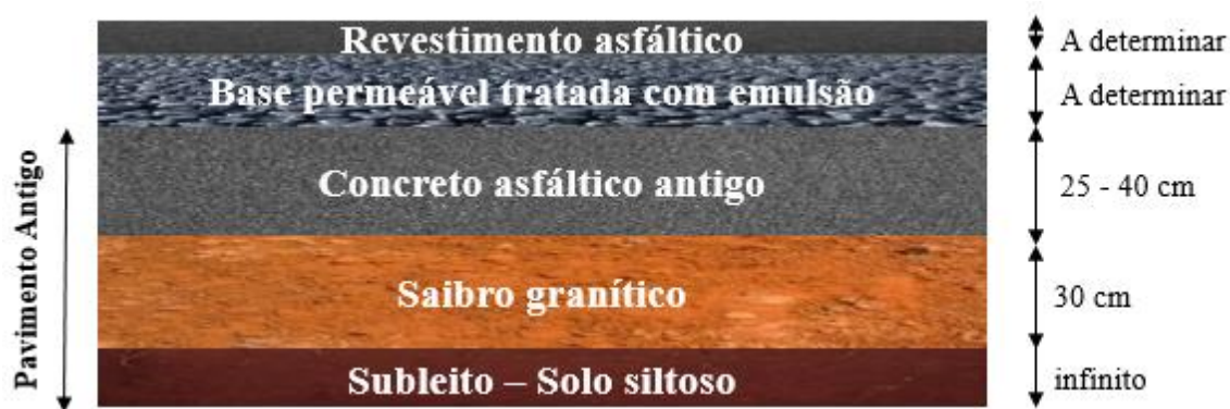
Figura 4: estrutura proposta para restauração do pavimento.
