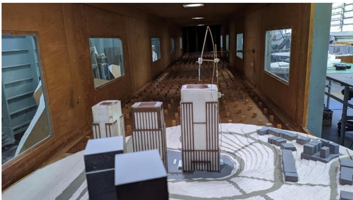
Figura 31 - Mesa na posição 180° e detalhes à barlavento
