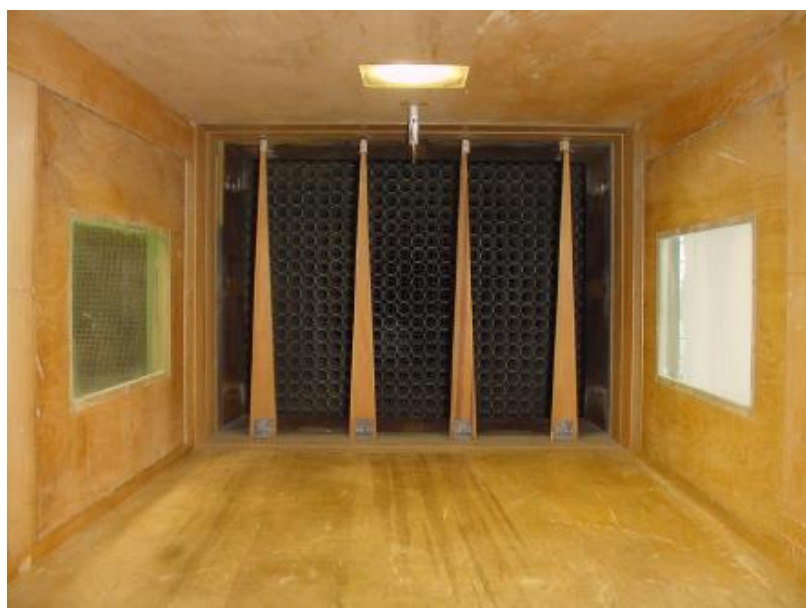
Figura 8 - Dispositivos de geração de perfil de velocidade para o expoente p = 0,11
