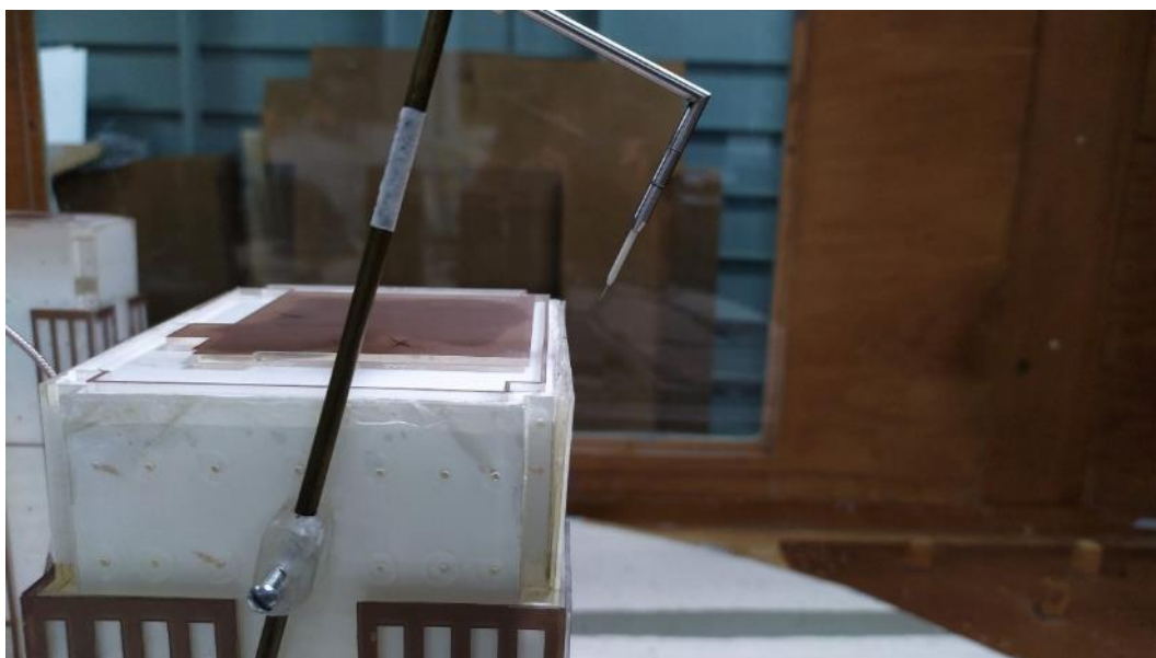
Figura 19- Posicionamento da sonda de fio aquecido
