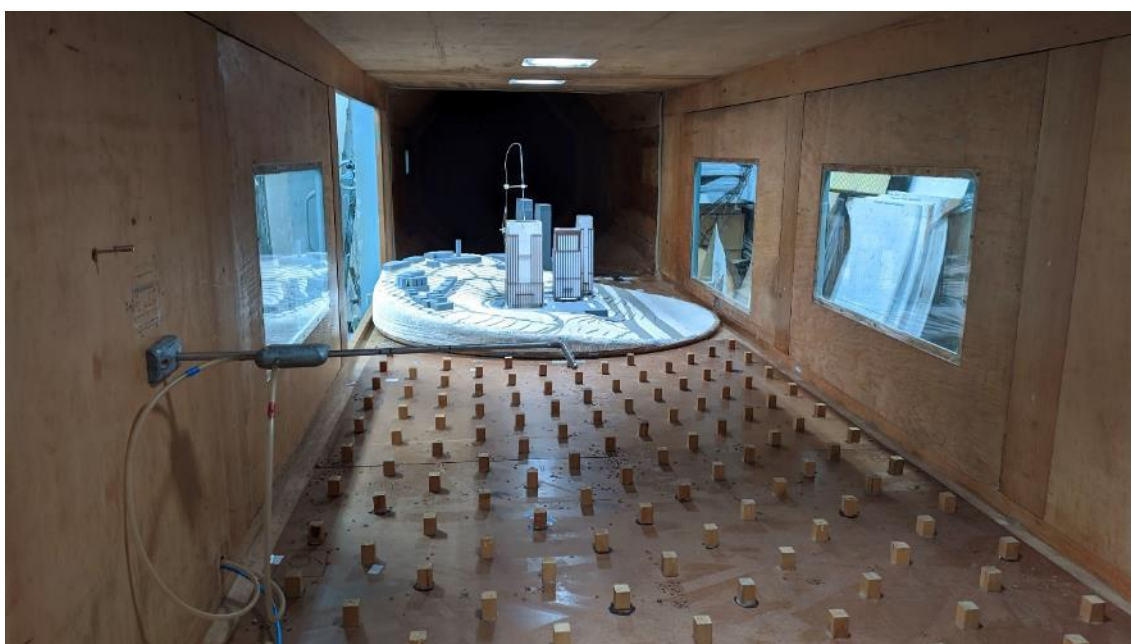
Figura 32 - Tubo de Pitot e mesa ao fundo na posição 180°
