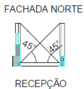
Figura B. 8: AHS na porta de entrada – fachada norte
