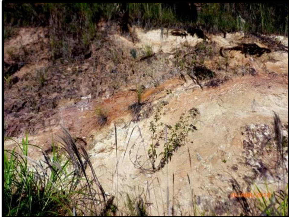
Figura 7.4 – Contato entre unidades, material geotécnico 1 – muito plástico sobre material geotécnico 2 – pouco plástico a plástico; registro de campo.
