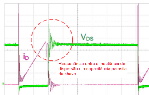
Figura 12: Tensão sobre a chave e comportamento da corrente sobre o diodo no Flyback não-ideal.
