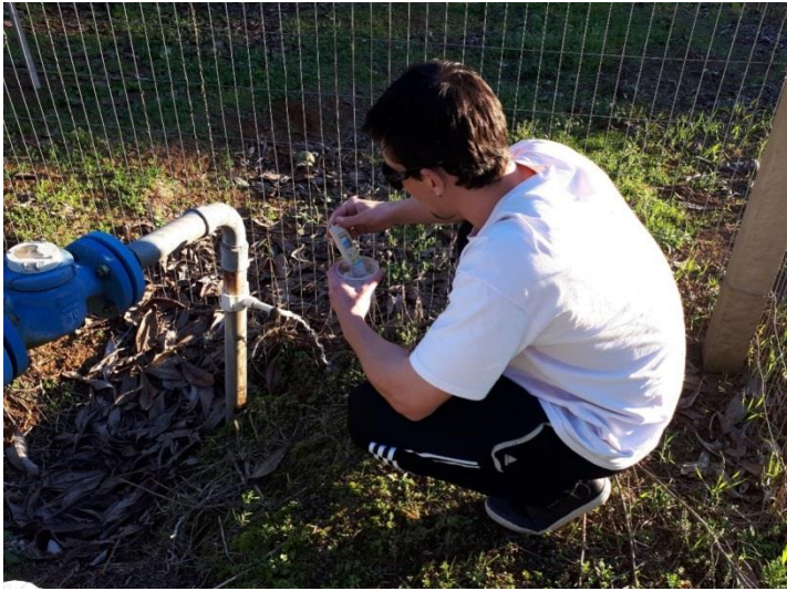
Figura 10. Análise hidroquímica com o uso de sonda multiparâmetro.
