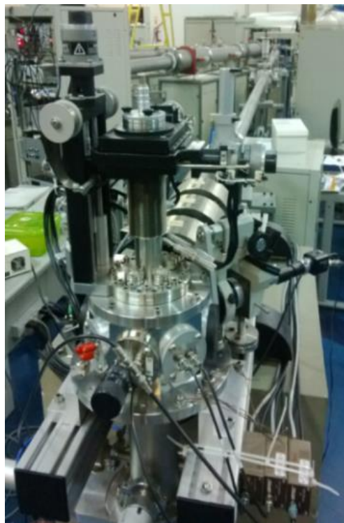
Figura 18: Imagem da câmara de irradiação da linha de microfioxe de íons do LII.
