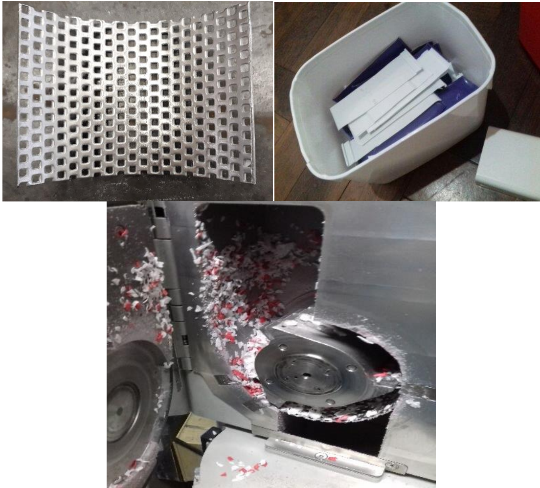
Figura 19 – Peneira com abertura de 4 mm (a); PP cortado em pedaços retangulares (b); moinho de facas (c)
