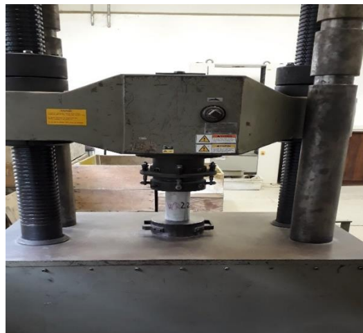
Figura 30 – Ensaio de compressão axial em corpo de prova
