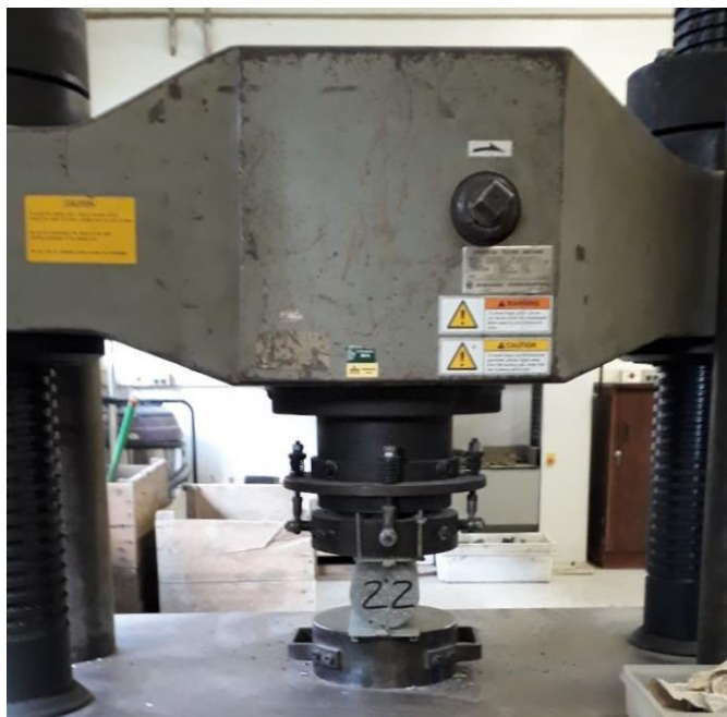
Figura 32 – Ensaio para determinar a resistência à tração por compressão diametral
