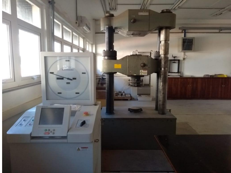
Figura 29 – Prensa hidráulica shimadzu modelo UH-I 2000kN
