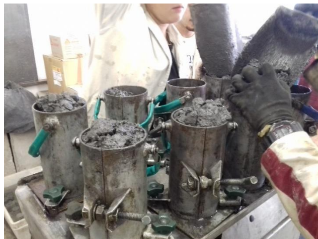
Figura 25 -Vibração de corpos de prova
