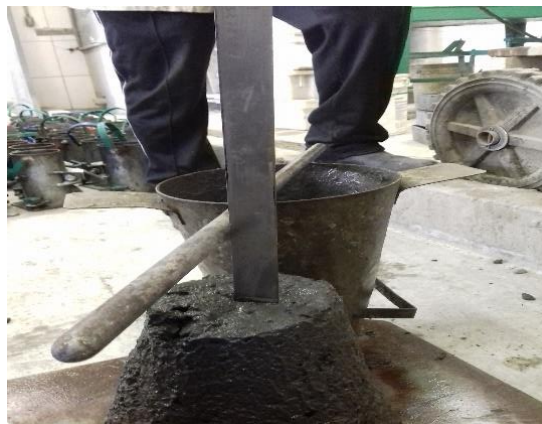
Figura 23 – Verificação do abatimento
