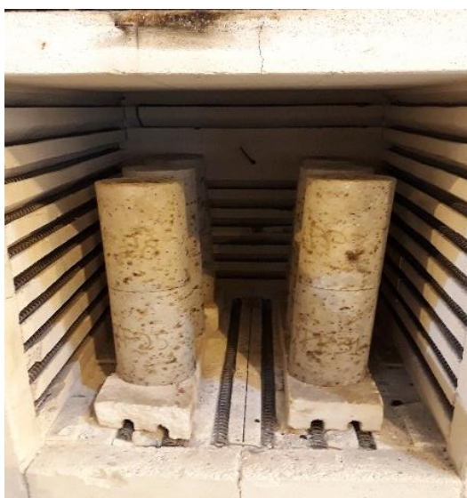
Figura 26 - Concreto com PP após exposição a 300^{\circ}\text{C}
