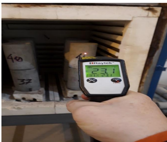
Figura 27 - CPs sendo resfriados em forno e verificados com termômetro laser
