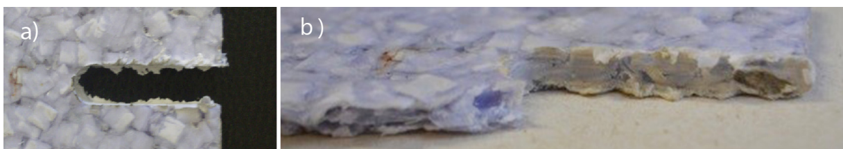
Figura 35 – Corte com usinagem na amostra PO/PMA: operação de corte (a) e aparência da superfície do corte (b)
