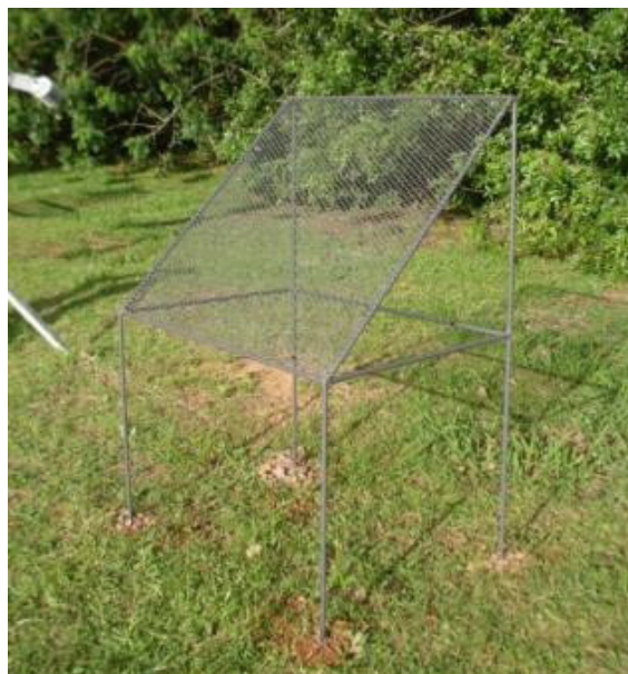
Figura 20 – Suporte ao ar livre para a realização do estudo de intemperismo natural
