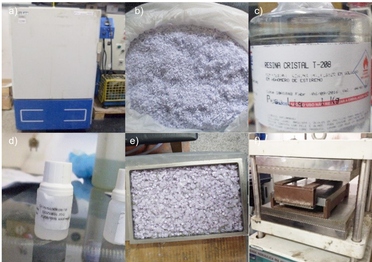
Figura 14 - Procedimentos: a) equipamento para secagem dos papéis, b) resíduo de papel menor, c) resina Poliéster, d) iniciador, e) material após a mistura colocado no molde, f) extração do compósito após a cura na prensa hidráulica
