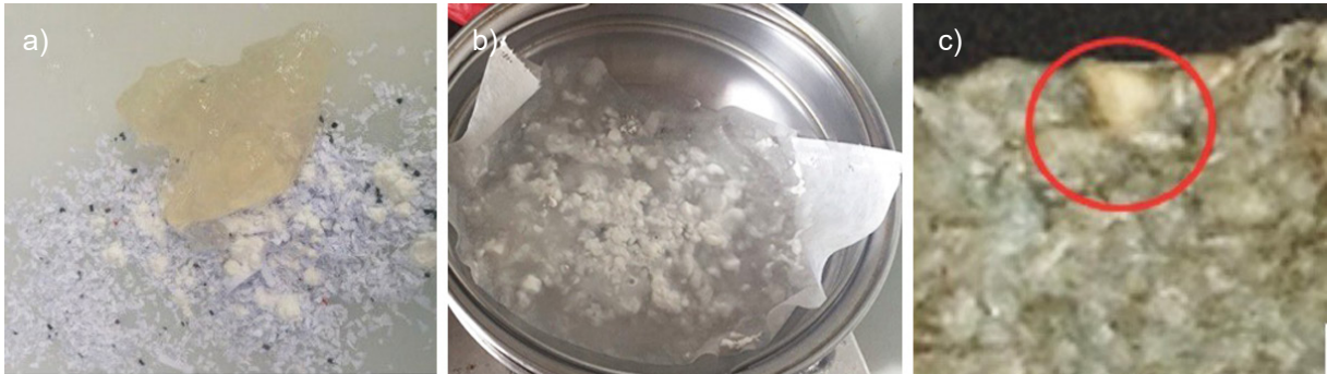
Figura 48 – Amido gelatinizado sem grumos (A), Grumos presentes no amido durante o processamento (B) e no material final (C) identificados pelo círculo
