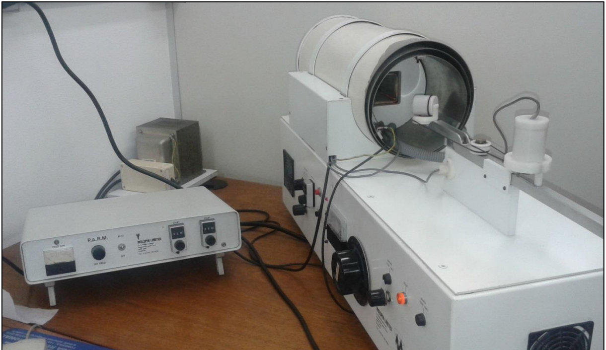
Figura 5 – Desmagnetizador (Molspin) utilizado para desmagnetização das amostras e obtenção dos espectros de coercividade.
