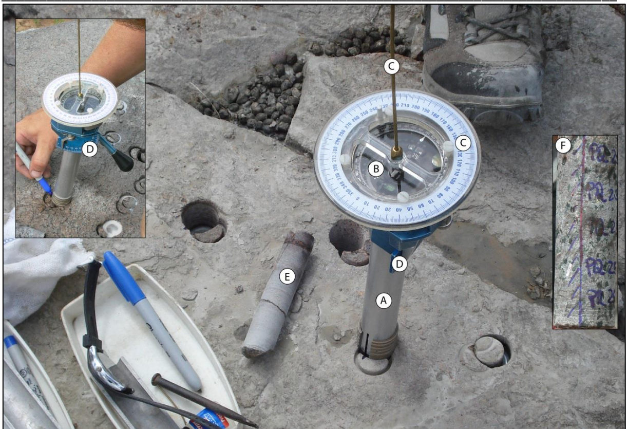
Figura 2 – Orientador de amostras cilíndricas (1" de diâmetro). (A) Cano de alumínio com ranhura na base. (B) Bússola tipo Brunton. (C) Transferidor de 360° com haste de metal perpendicular centralizada. (D) Transferidor de 90°. (E) Cilindro amostrado. (F) Cilindro orientado e identificado.
