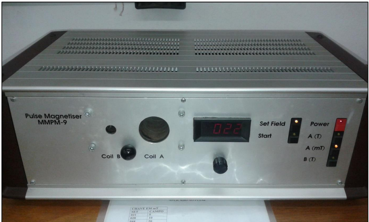
Figura 5 – Magnetômetro do tipo Pulse (Magnetic Measurements) utilizado para obtenção da Magnetização Remanente Isotermal.
