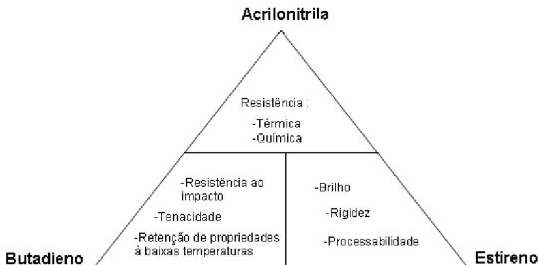
Figura 17: Triângulo de Propriedades do ABS adaptado de [37]
