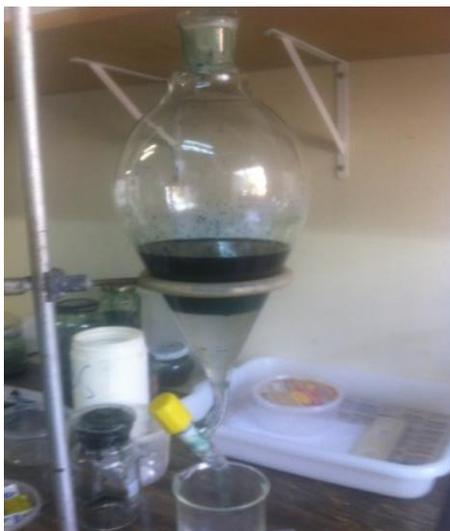
Figura 22: Imagem do aparato mostrando a separação da PAni/DBSA –tolueno da água com o DBSA não reagido
