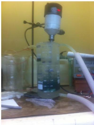
Figura 20: Imagem do aparato usado na polimerização por Emulsão da Anilina. Foto do autor.
