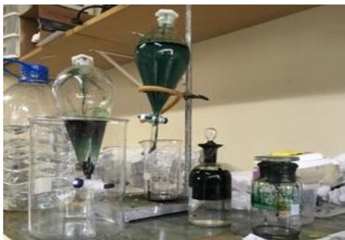
Figura 21: Imagem do aparato mostrando o processo de solubilização da PANi/DBSA em tolueno e separação da fase aquosa.
