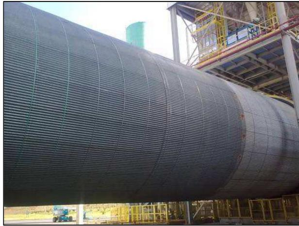
**Figura 21** – Secador horizontal de partículas
