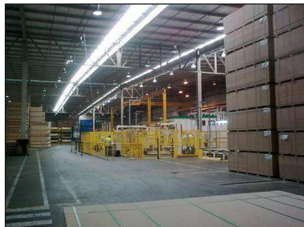
**Figura 28** – Sistema automático de empacotamento
