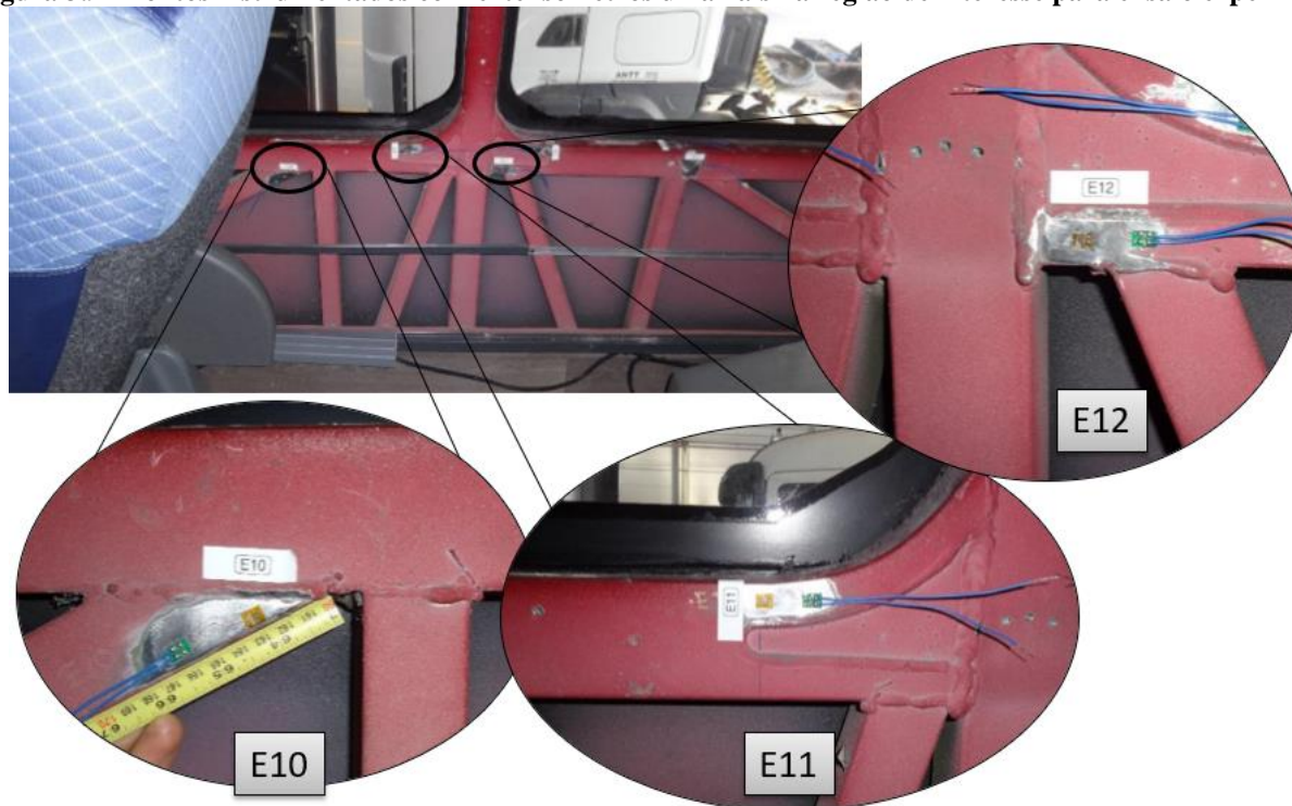
Figura 3.9 - Pontos instrumentados com extensômetros uniaxiais na região de interesse para ensaio experimental
